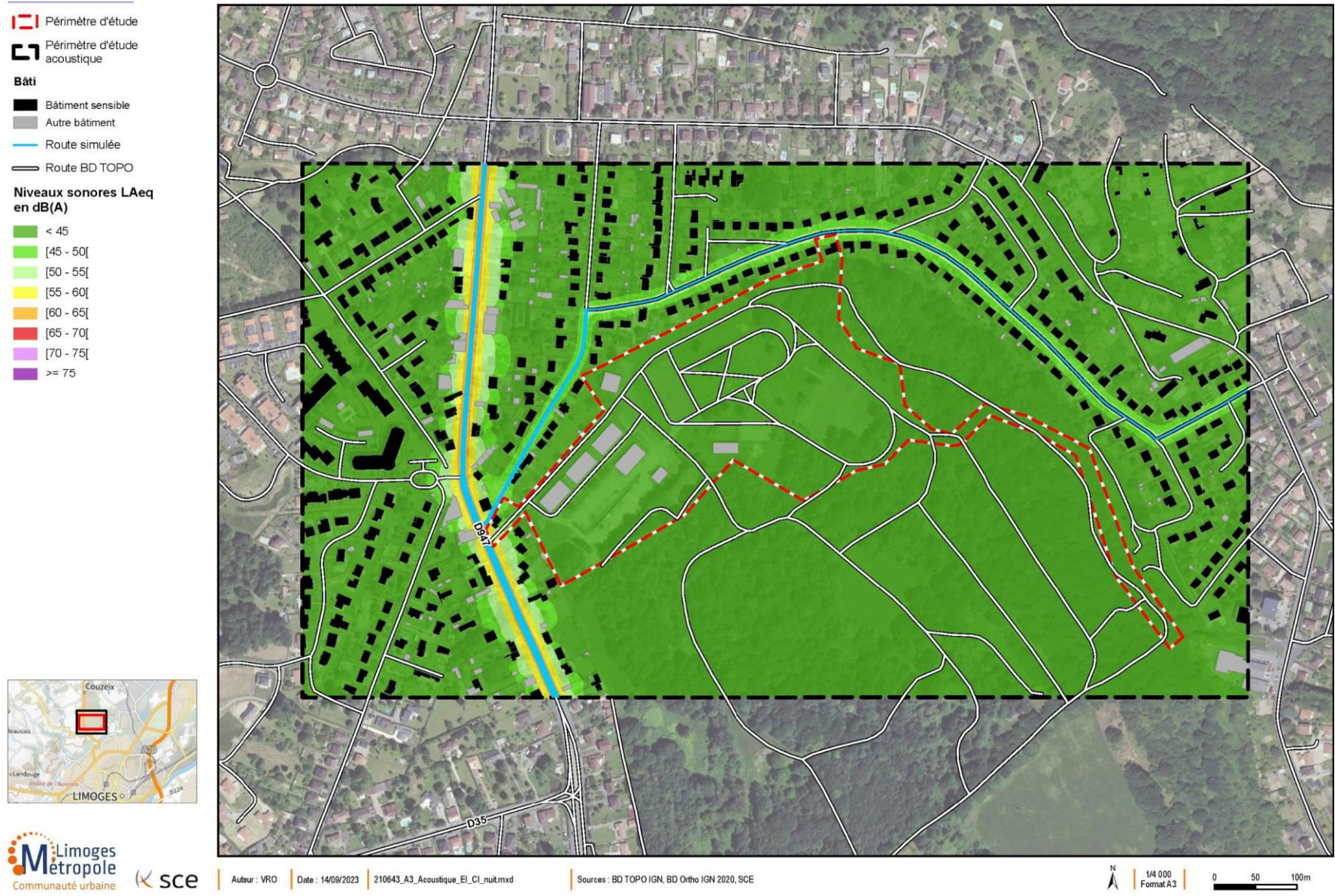
Figure 80 : Cartographies acoustiques par courbes isophones à 2 m du sol en période nocturne (22h-6h) à l'état actuel
